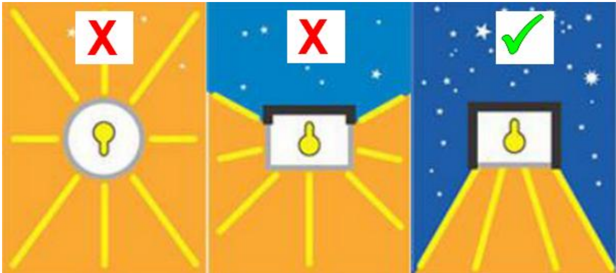
Abbildung 9: Schematische Darstellung der Ausleuchtung in Abhängigkeit von der verwendeten Abschirmung des Leuchtmittels. Links: Ohne Abschirmung, Mitte: Unzureichende Abschirmung. Rechts: Ideale Abschirmung mit nur nach unten gerichtetem Lichtkegel.
